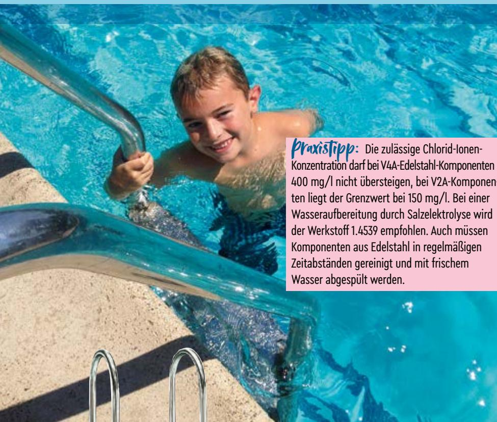
**Praxistipp:** Die zulässige Chlorid-Ionen-Konzentration darf bei V4A-Edelstahl-Komponenten 400 mg/l nicht übersteigen, bei V2A-Komponenten liegt der Grenzwert bei 150 mg/l. Bei einer Wasseraufbereitung durch Salzelektrolyse wird der Werkstoff 1.4539 empfohlen. Auch müssen Komponenten aus Edelstahl in regelmäßigen Zeitabständen gereinigt und mit frischem Wasser abgespült werden.
